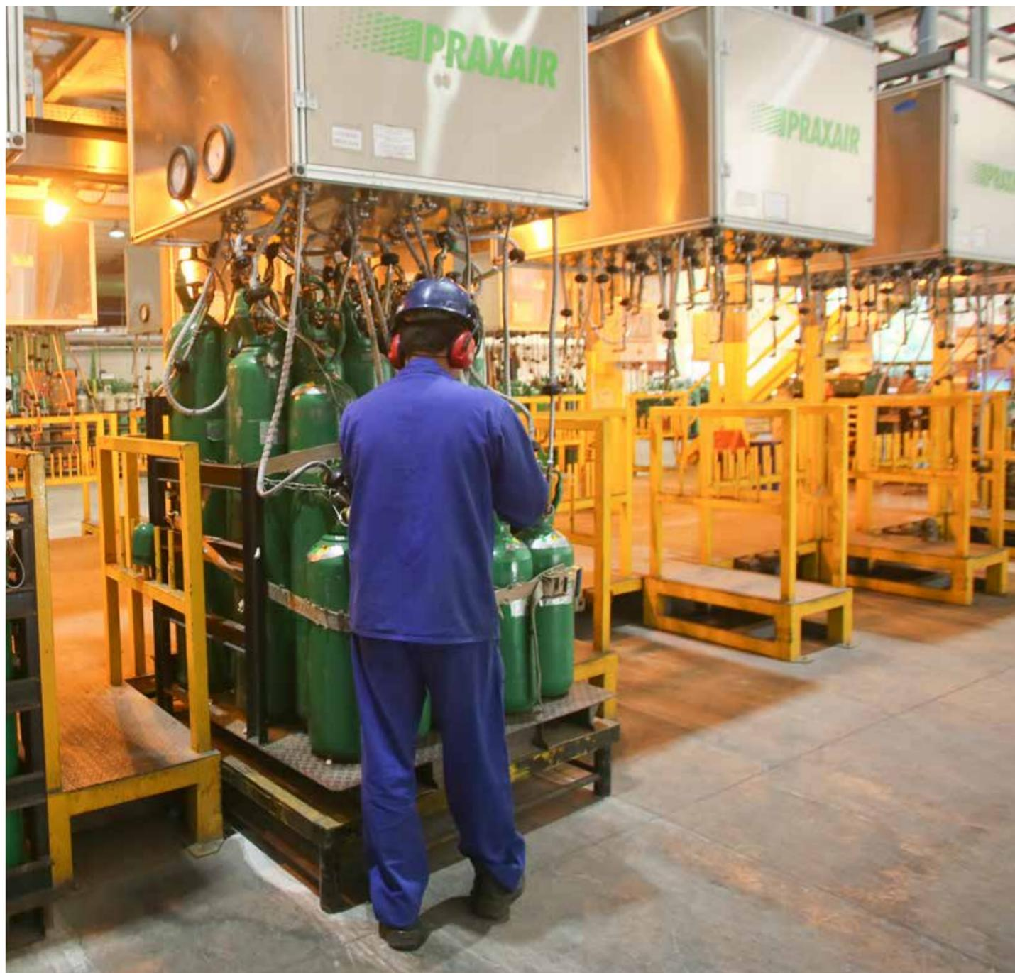
Estação de enchimento de alta pressão: cilindros de oxigênio para o segmento medicinal
